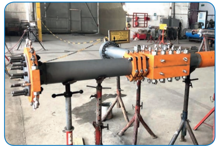
Установка зажимов INTRA SEAL и банджа INTRACOMPOSITE на трубный узел для испытаний
