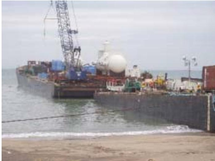
**Рисунок 14.2 Стыковка транспортной баржи (слева) со стационарно закрепленной баржей (справа)**
