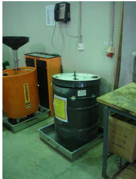
Фото 15 Немедленное устранение замечания об отсутствии защитных поддонов, ОБТК
