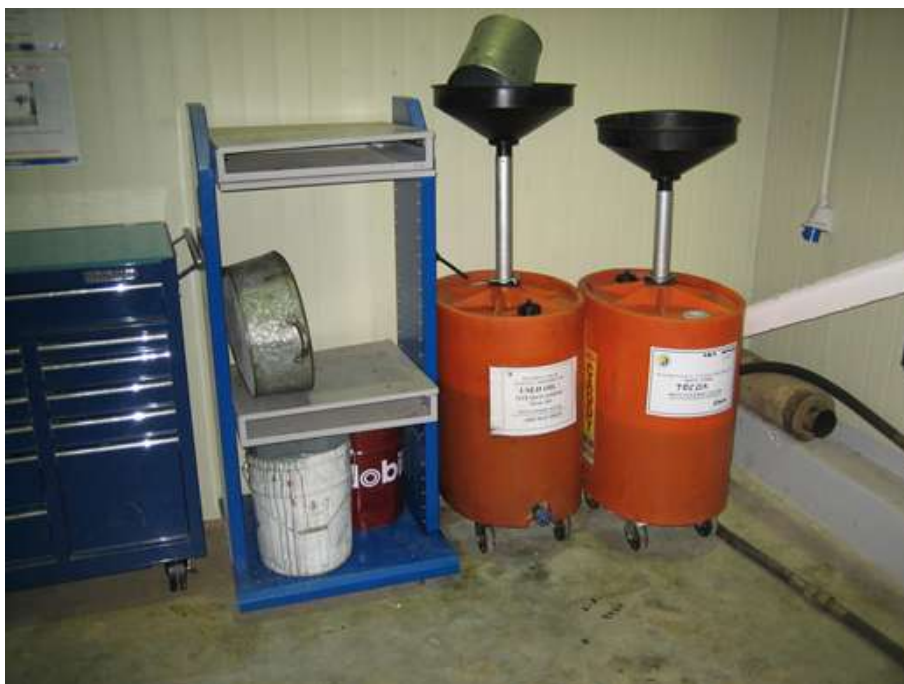
Фото 13 Маркированные емкости с отработанным маслом без защитных поддонов, Ноглики
