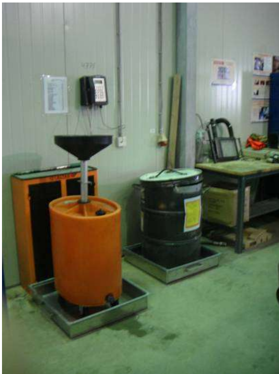
Фото 15 Немедленное устранение замечания об отсутствии защитных поддонов, ОБТК
