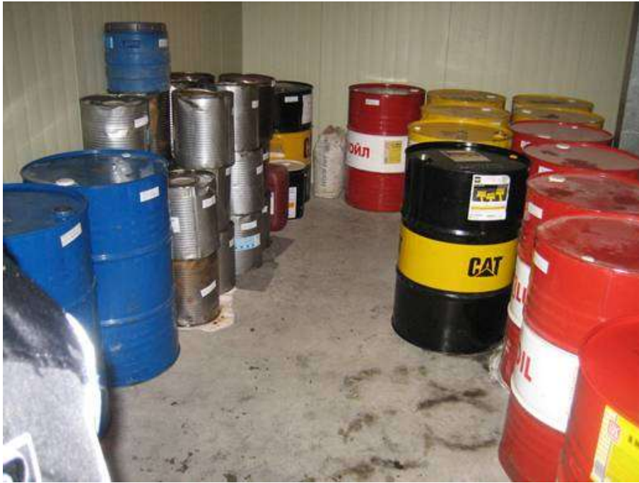
Фото 27 Бочка с биоцидом без защитного поддона, Ноглики
