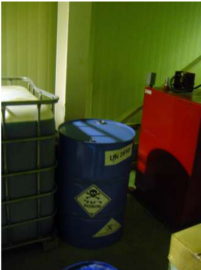
Фото 27 Бочка с биоцидом без защитного поддона, Ноглики
