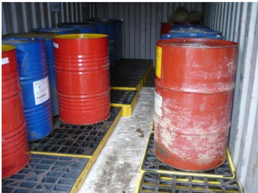
**Фото 18. Бочки с отработанным маслом в ненадлежащих средствах вторичной локализации разливов, Ноглики**
